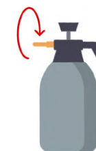
Régler la buse en faisant une rotation
